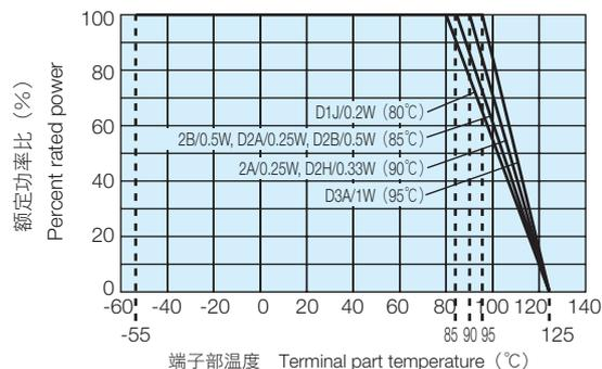
超过上述端子部温度使用时，请根据负荷减轻特性曲线减小额定功率后使用。
