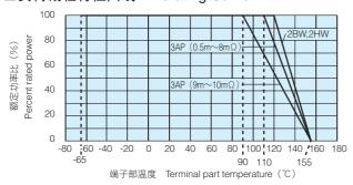
超过端子部温度使用时,请根据上图负荷减轻特性曲线减小额定功率后使用。
