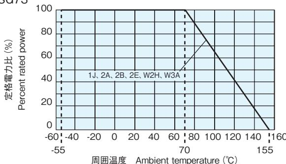
周囲温度70°C以上で使用される場合は、左図負荷軽減曲線に従って、定格電力を軽減して御使用ください。
