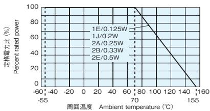
周囲温度70°C以上で使用される場合は、左図負荷軽減曲線に従って、定格電力を軽減して御使用ください。
