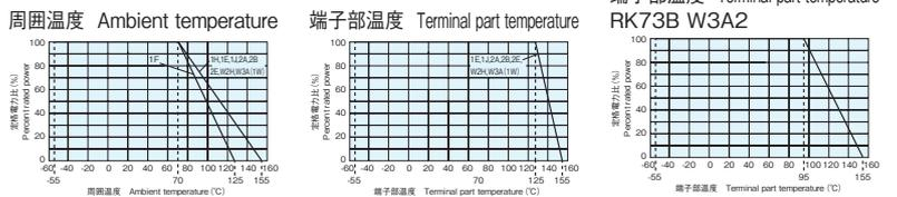
周囲温度70°C以上で使用される場合は、上図に示す負荷軽減曲線に従って、定格電力を軽減して御使用ください。
