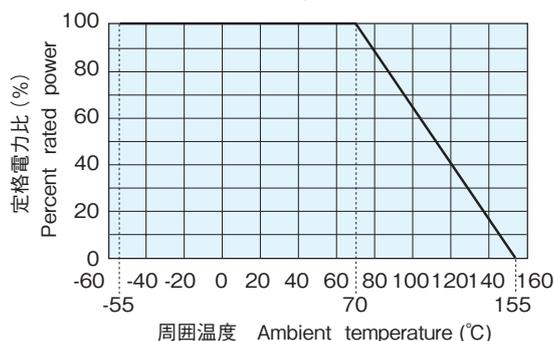
周囲温度70℃以上で使用される場合は、左図負荷軽減曲線に従って、定格電力を軽減して御使用ください。
