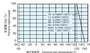
周囲温度70°C以上で使用される場合は、上図負荷軽減曲線に従って、定格電力を軽減して御使用ください。
