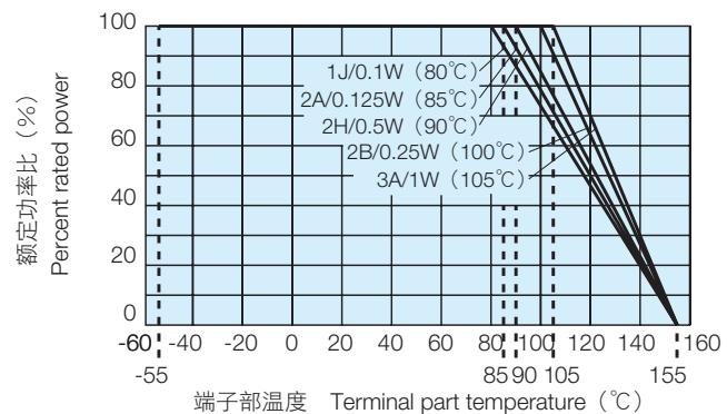
超过上述端子部温度使用时，请根据负荷减轻特性曲线减小额定功率后使用。
