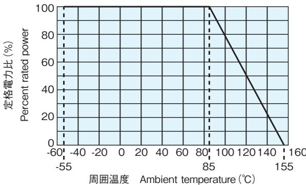
周囲温度85°C以上で使用される場合は、上図負荷軽減曲線に従って、定格電力を軽減して御使用ください。
