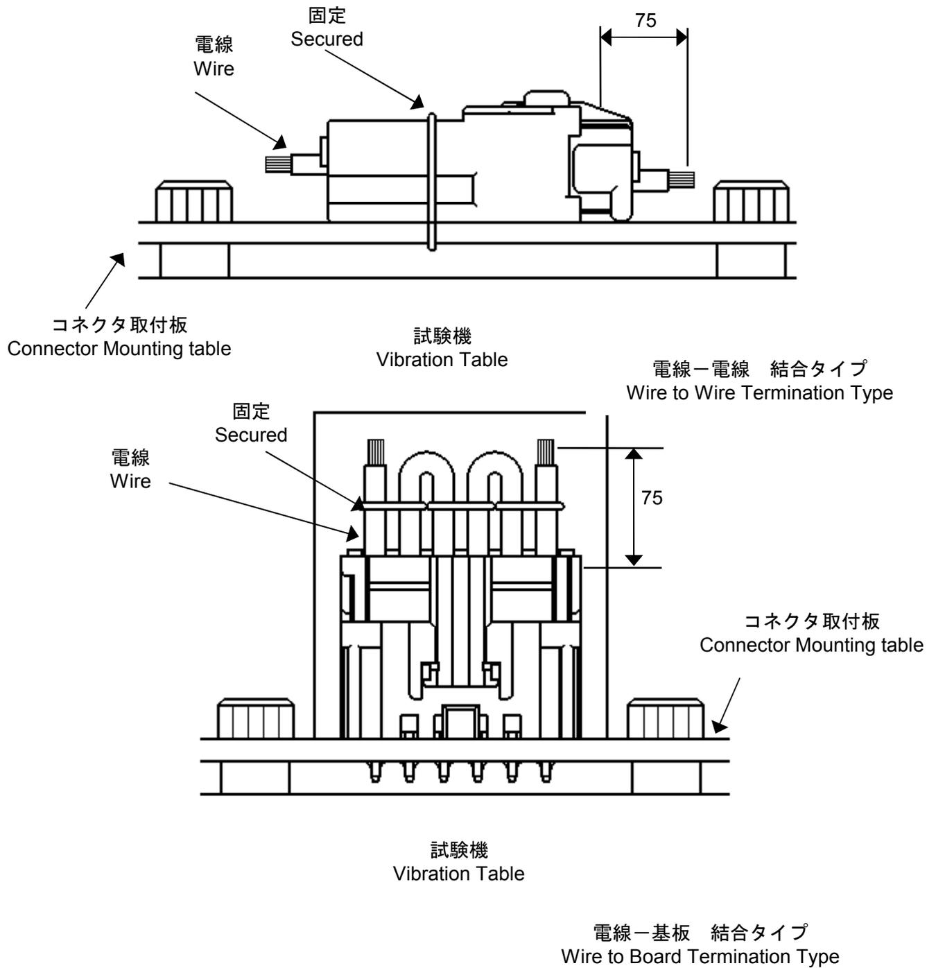
Fig. 8 低周波振動試験及び衝撃試験のコネクタ取付方法
