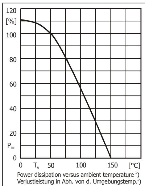
Power dissipation versus ambient temperature<sup>1)</sup>
