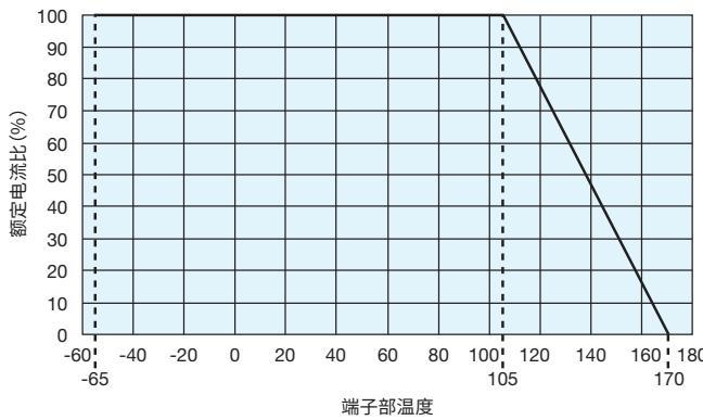
超过上述额定端子部温度使用时，请根据功率降额曲线减小额定电流后使用。
