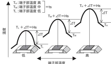
表面温度上升，由于是用本公司测定条件测定的，根据使用状况、使用基板不同，数值也有不同，因此在使用时应另行询问。
